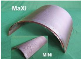
**Ausführung:** GFK (Glasfaserverstärkter Kunststoff) Grundkörper mit Kupfer-Riffelfolie laminiert. Die unteren Längskanten sind aus Kupfer-Gitter zur Be- und Entlüftung. Diese Unterkanten sind rinnenförmig geformt zur Aufnahme der "Rund-Kupfer-Einlage" alt. Edelstahl-Einlage (VA) zur Befestigung des First-Elementes bzw. zusätzliche Bindung der oberen Reetlage. Inkl. Rund-Kupfer-Einlage.
